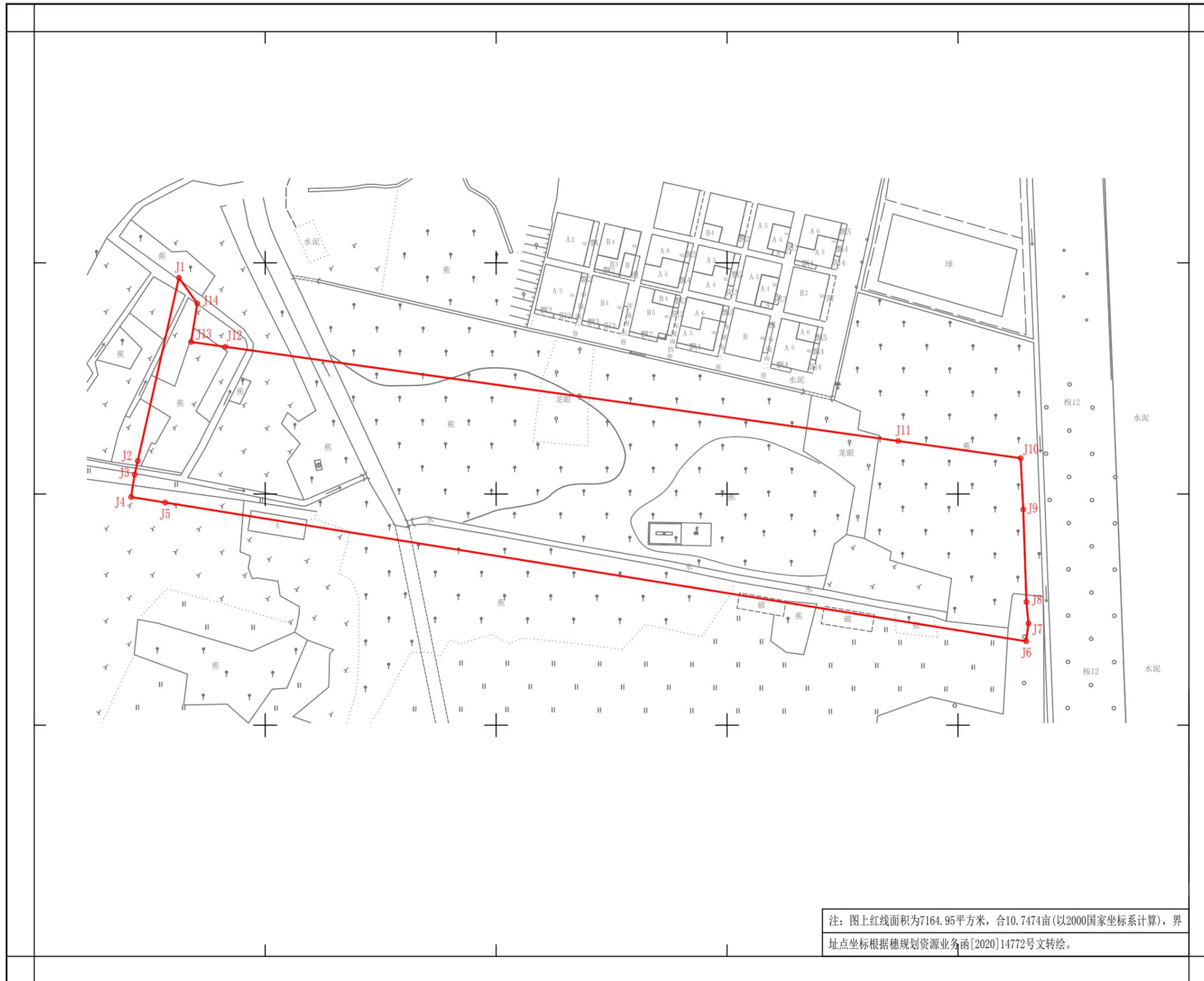
注:图上红线面积为7164.95平方米,合10.7474亩(以2000国家坐标系计算),界址点坐标根据穗规划资源业务函[2020]14772号文转绘。
