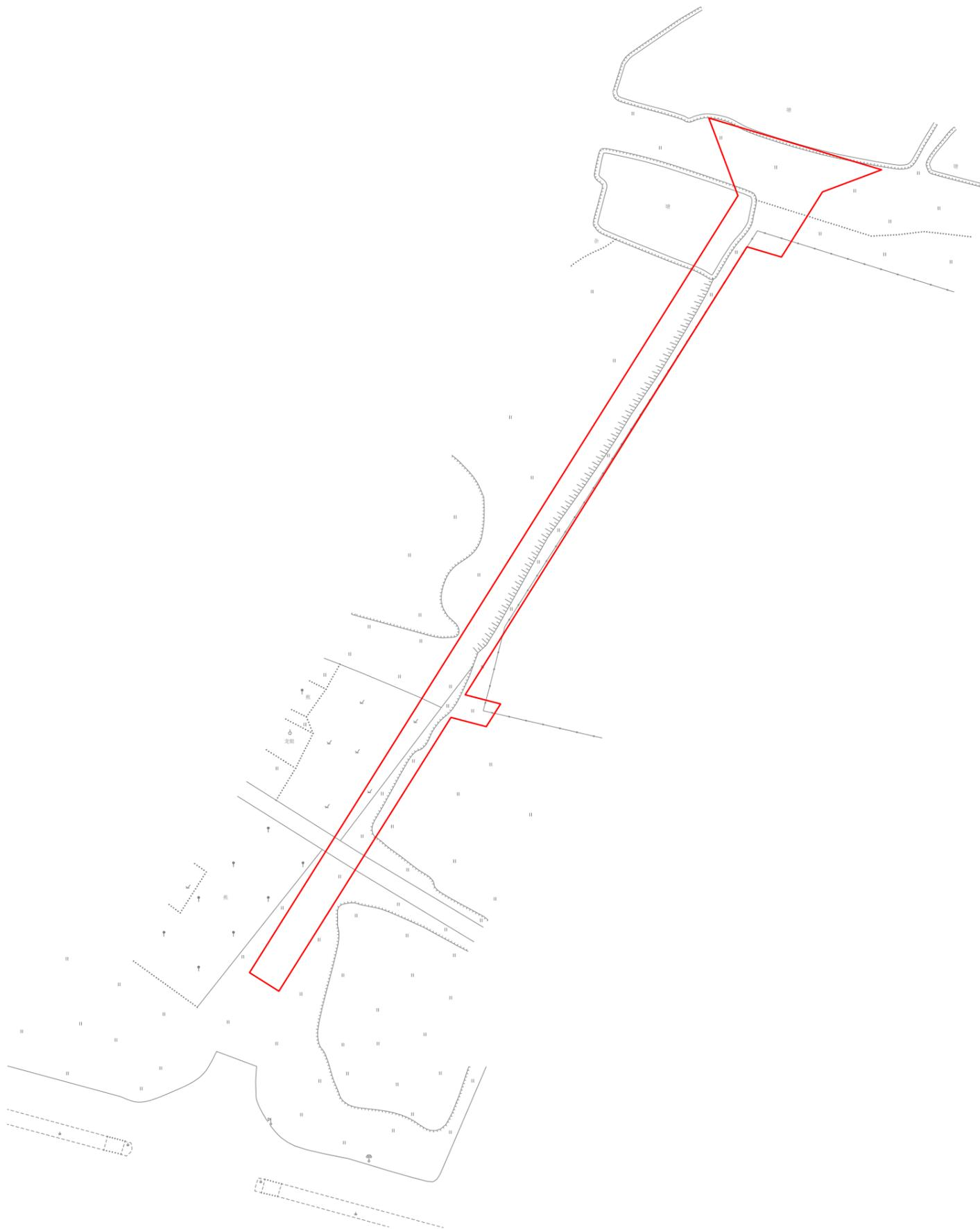
注：图上红线根据2024土21B216（2024KJ01140415）勘测定界范围线提取集体土地范围转绘。
